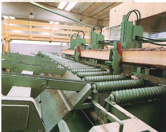
Impianto con segatronchi per legni di conifera. Log band saw plant for conifer wood.
