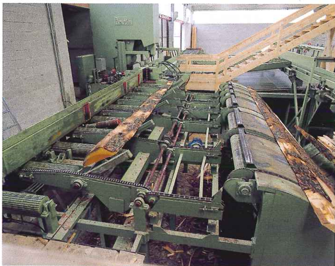
Refendino con circuito automatico (operatore seduto). Band resawing machine with automatic circuit (seated operator).
