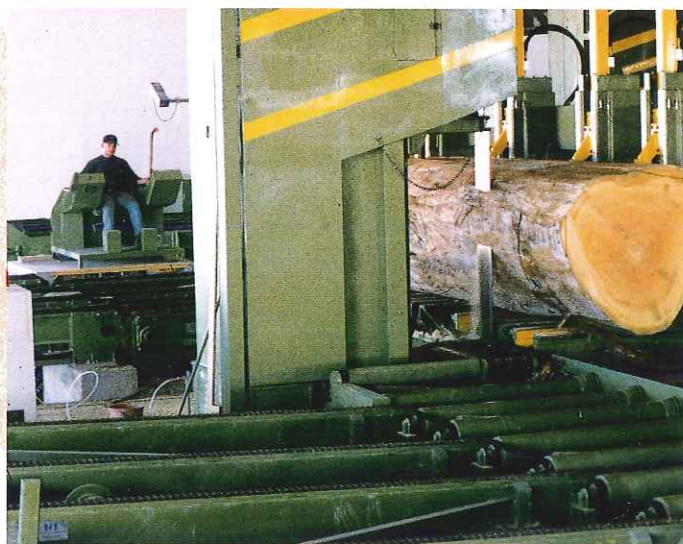
Impianto con segatronchi per legni duri. Log band saw plant for hard wood.
