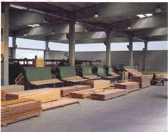
Linea automatica di selezione in lunghezza per tavole refilate. Automatic trimmed board length sorting line.
