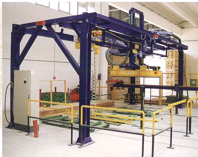
Movimentatore a depressione per strati di tavole. Vacuum handling systems for layers of boards.
