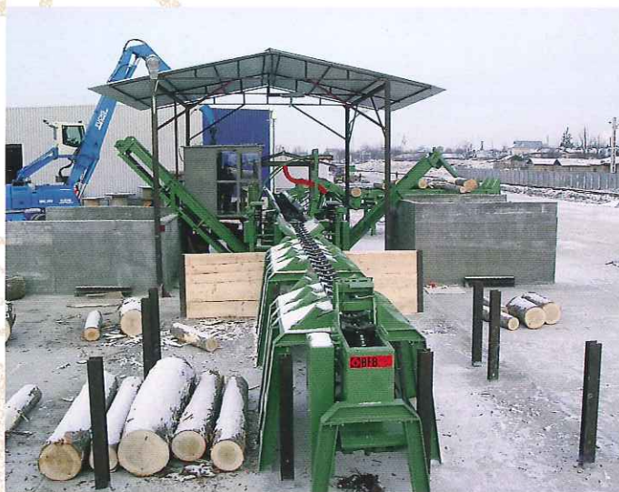
Linea di troncatura per tronchi con sega a catena. Log cut-off line for log with chain saws.
