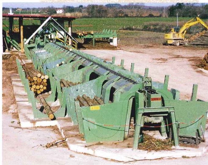
Linea di selezione tronchi. Sorting line for logs.
