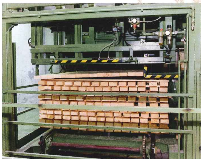
Vista particolare di un accatastatore per semilavorati. Detailed view of semi-machined product stacker.
